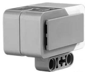
Рис. 1. Гіроскопічний датчик набору Lego Mindstorms EV3
