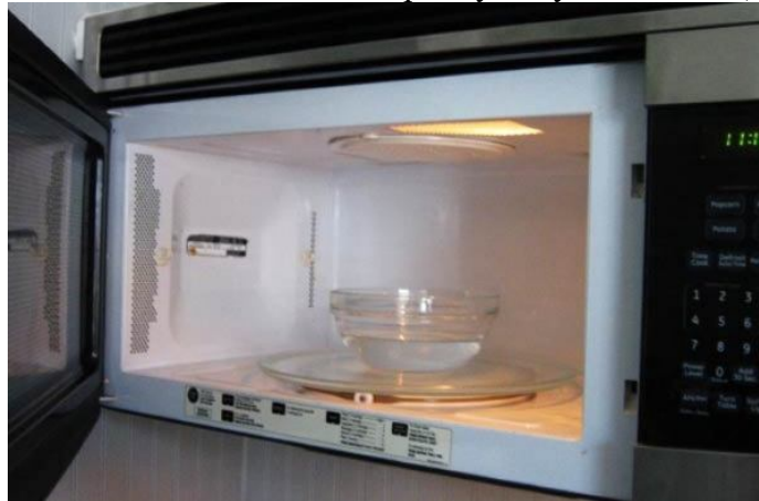
Рис. 1. Дослід для визначення корисної потужності та ККД мікрохвильової печі.
